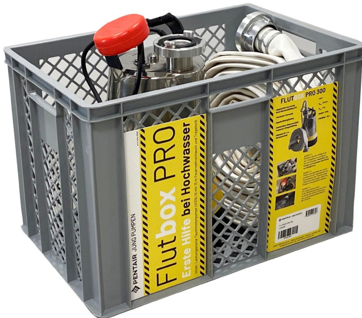
Bild 1: Die Flutbox Pro 300 ist ein professionelles Erste-Hilfe-Set zur Beseitigung von Überschwemmungen aus Tiefgaragen oder anderen größeren Untergeschossen. Sie besteht aus einer stabilen Transportbox, einer leistungsstarken Schmutzwasserpumpe (28 m 3 /h) und einem 15 m langen Feuerwehrschauch (Ø 52 mm, mit Storz-C-Kupplung).
