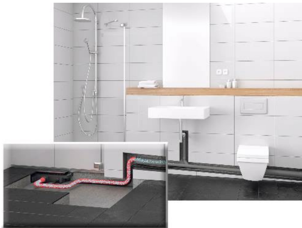
Abb. 2: Die Technik: Wird der Duschboden auf das Fußbodenniveau abgesenkt, liegt das alte Abwasserrohr in der Wand oft zu hoch und das Wasser kann nicht abfließen. Hier hilft die Bodenablaufpumpe Plancofix Connect, die das Abwasser leise in das vorhandene Abwasserrohr pumpt.
